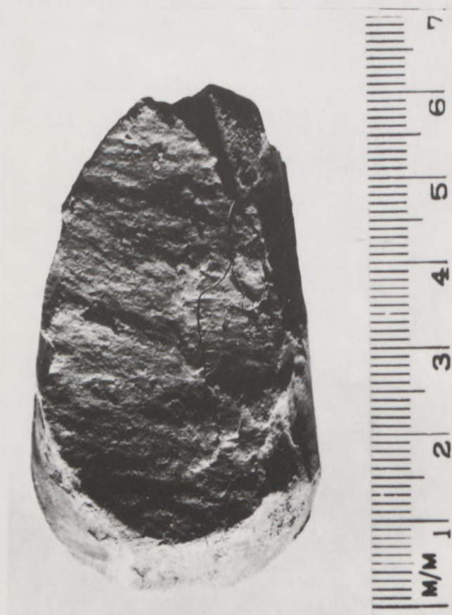
Fig. 29. A joint surface in the blue London Clay at Wraysbury, Buckinghamshire. Une surface d'un joint dans le blue London Clay à Wraysbury, Buckinghamshire.
